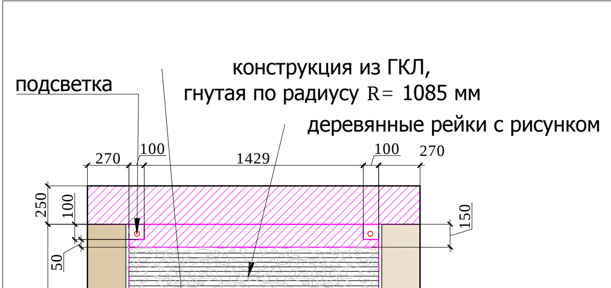
Разрез потолка 2-2.Бочка кедровая .Помещение №6
