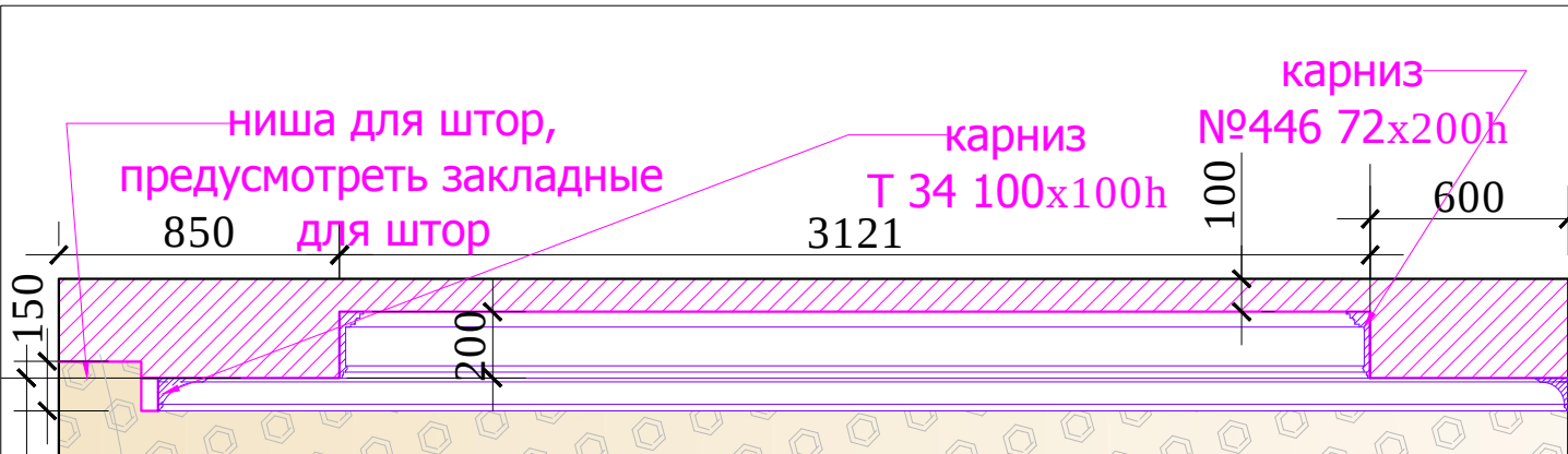
Разрез потолка 6-6.Спальня 2.№13
