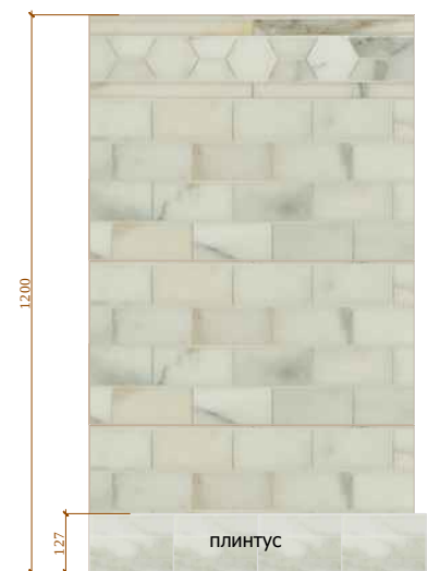
Схема раскладки мраморной плитки, h условно 1200
