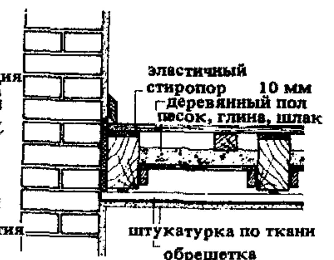
9. Звукоизолирующая способность против ударного шума перекрытия по деревянным балкам
