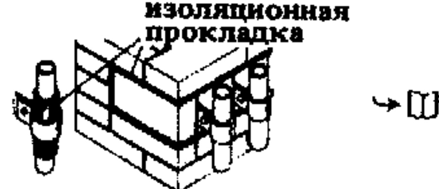
8. Изоляция труб при креплении к кладной пробке в стене
