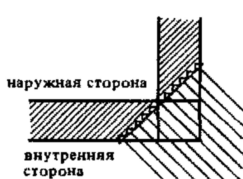
9. При большой внутренней поверхности тепловых мостиков значительно снижается потеря тепла с единицы площади
