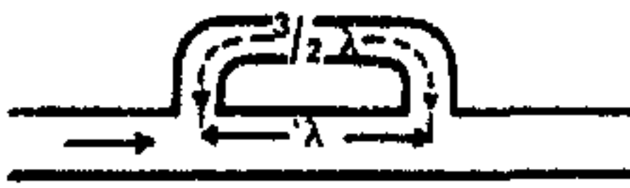
1. Устранение шумов при помощи интерференции \lambda = 340/f м (f, Гц) (по Тинхаузу)
