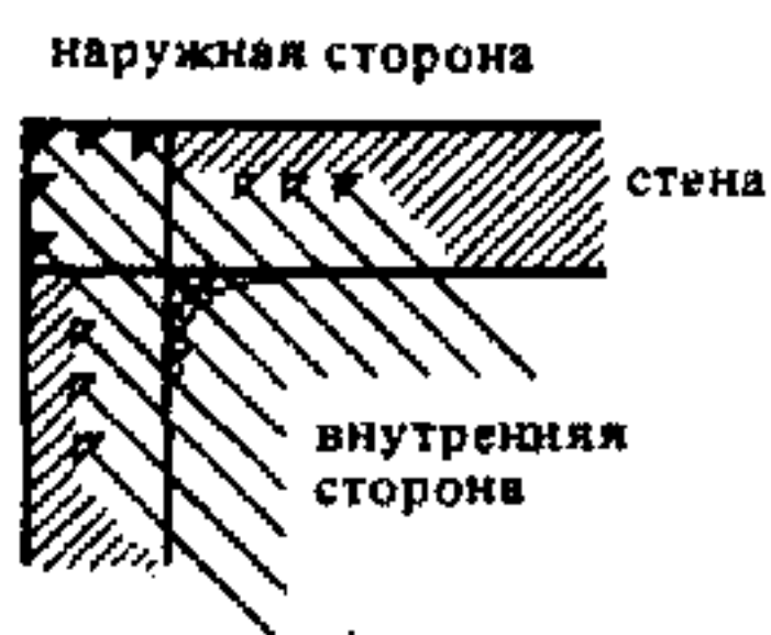
8. При большой внешней поверхности тепловых мостиков возникает конденсат (большие потери тепла на каждой единице площади)
