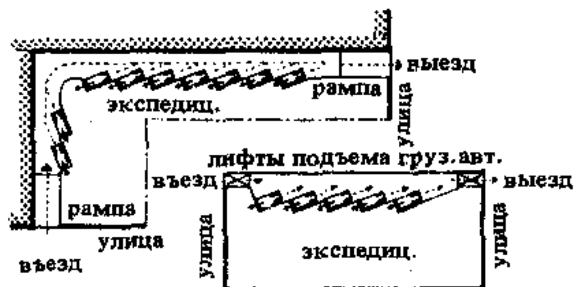
12. Возможности подъезда к подвальным помещениям многоэтажного универмага по рампам и с использованием лифта для грузовых автомобилей. М 1:2000
