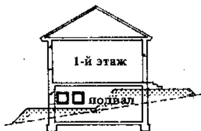
2. При небольших уклонах путем подсыпки вынужденной земли можно создать на участке террасу
