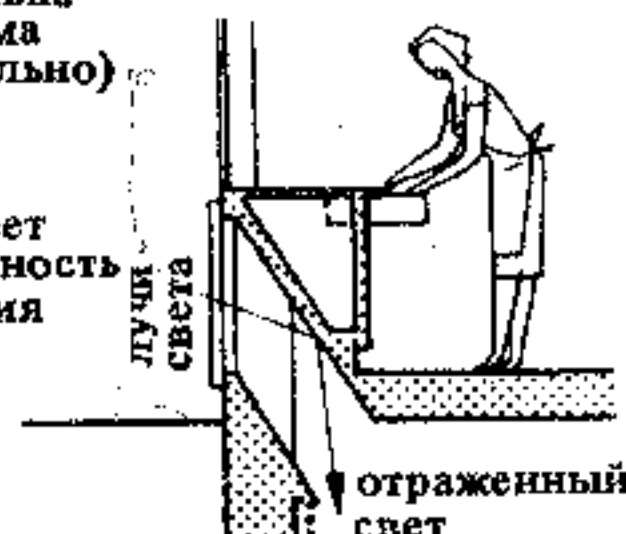
6. При низкой отметке пола 1-го этажа окна в подвал располагают в подоконных частях стен 1-го этажа и закрывают их вертикальной решеткой. Возможен конденсат
