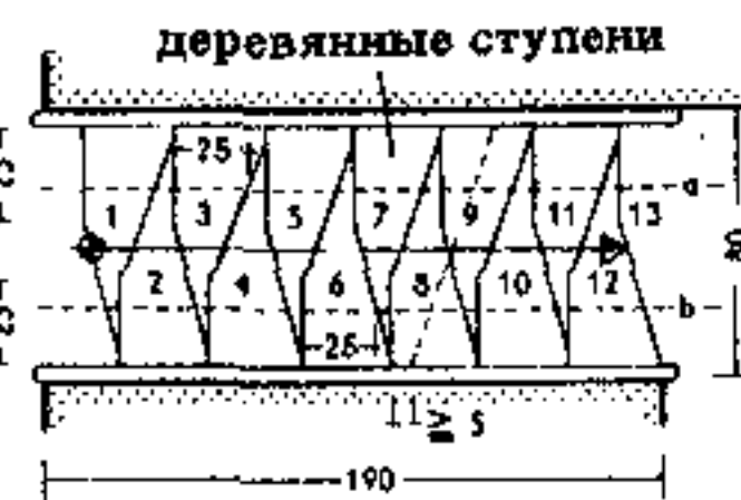
5. План. Ширина ступеней по линиям a и b \geq 20 см
