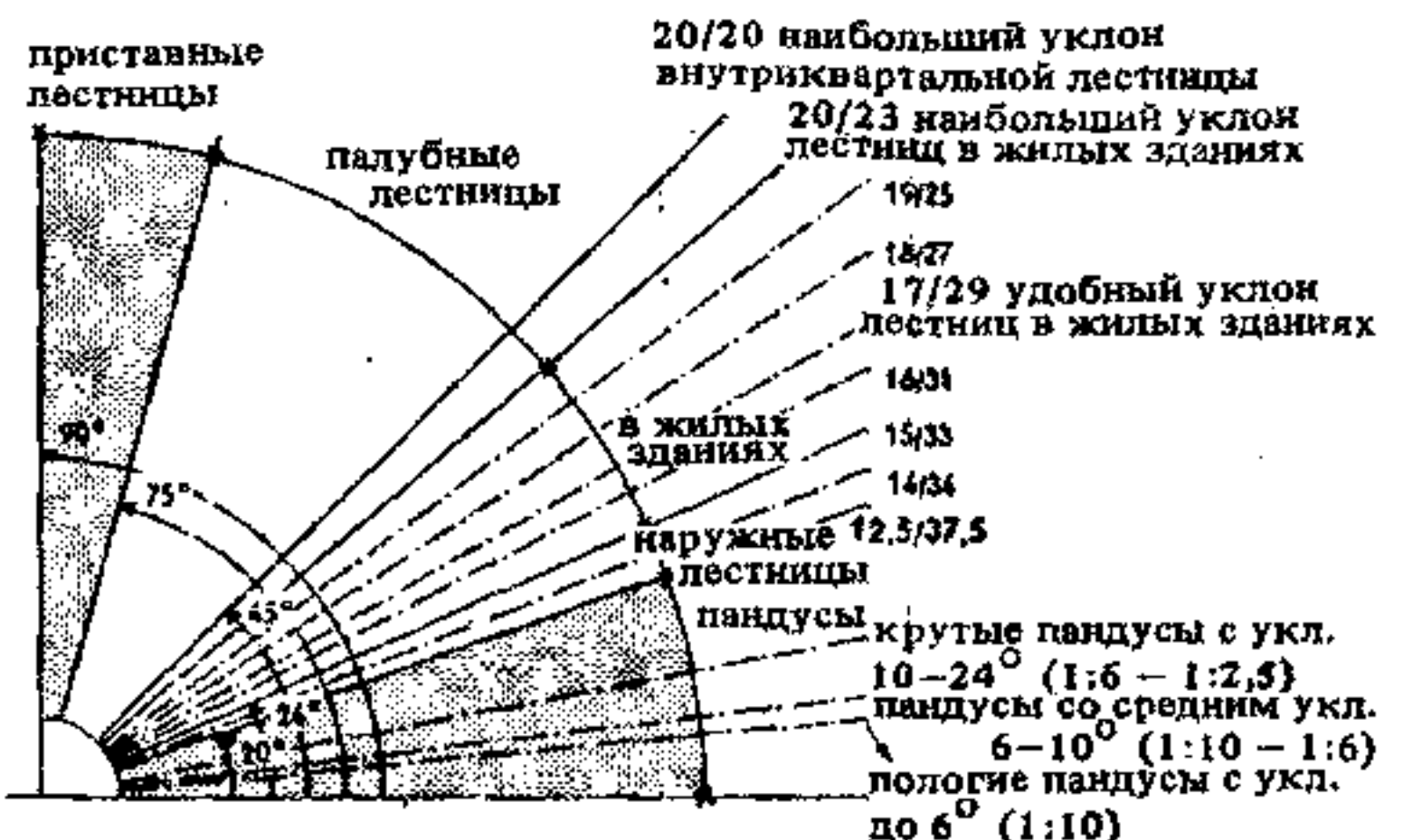
9. Обычные уклоны для пандусов, наружных, внутренних, рабочих, палубных лестниц и стремянок
