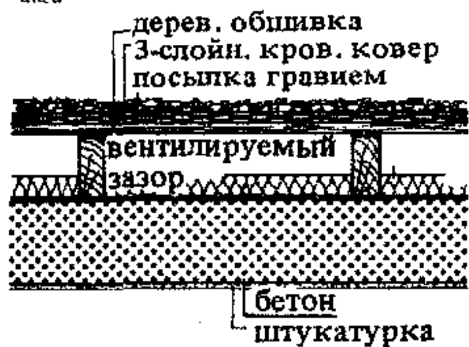
5. Холодная крыша тяжелой конструкции
