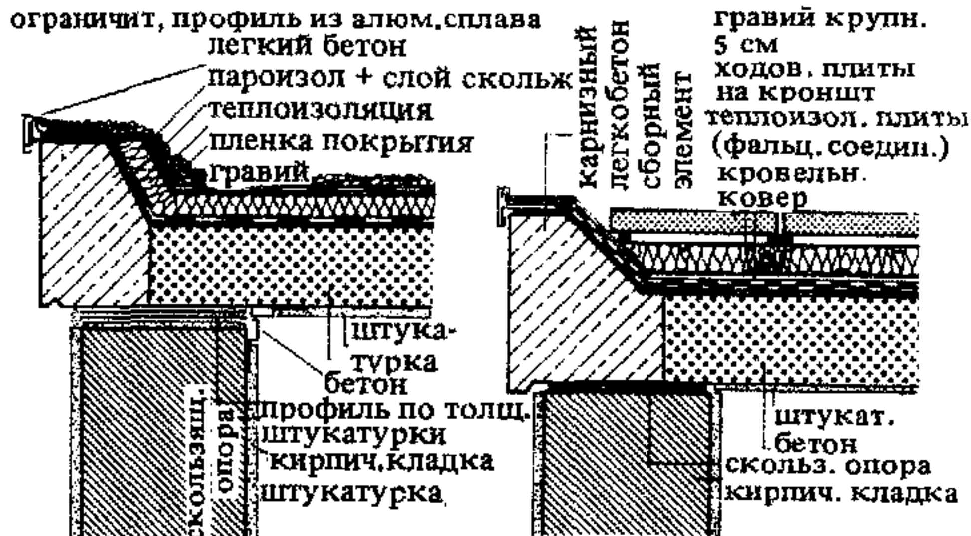
2. Водонепроницаемая бетонная крыша (система «Верман»)
