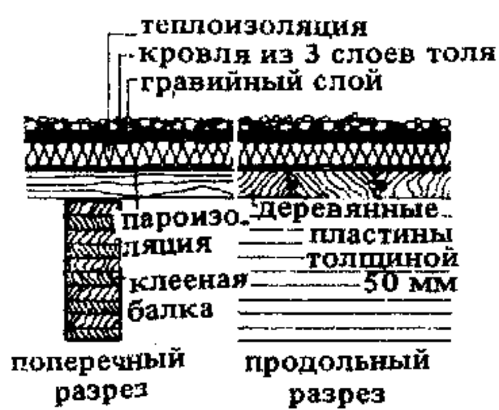
1. Теплая кровля с клееными балками. С внутренней стороны — обшивка стропильными пластинами
