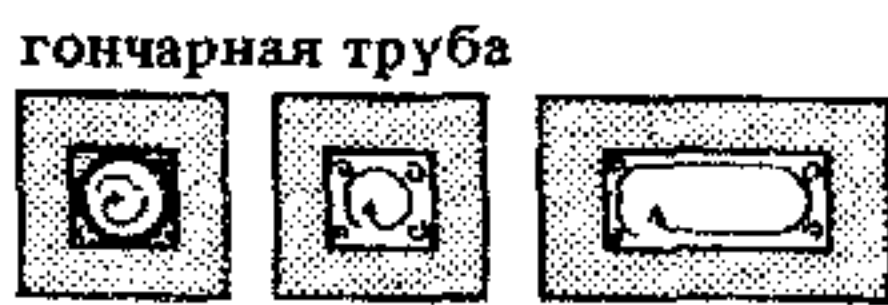
5. Влияние формы поперечного сечения труб на тягу
