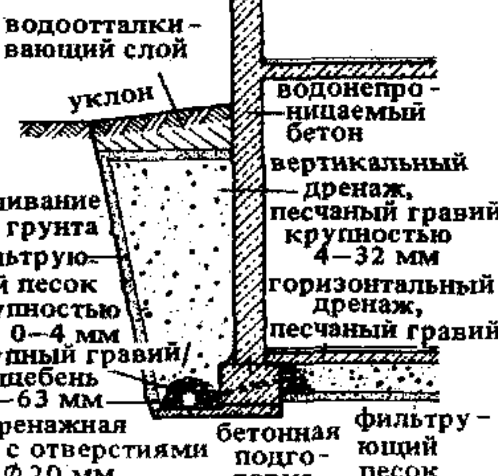
14. Трубчатый дренаж со ступенчатым фильтром
