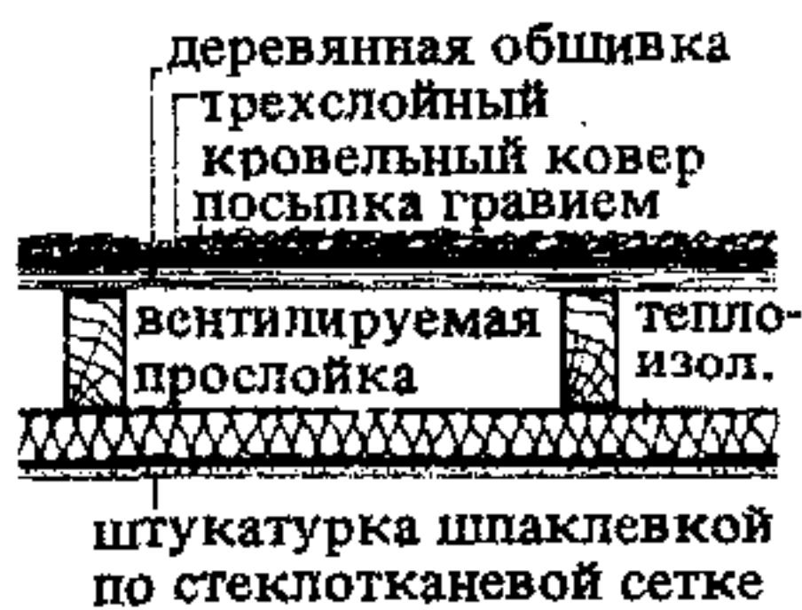
6. Холодная крыша легкой конструкции
