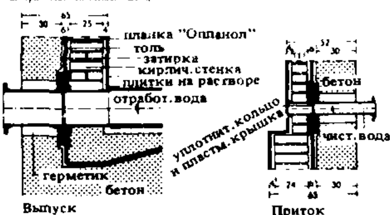
3. Выпуск и приток воды в ваннах с гидравлическим подъемом и облицовкой. Выпускной и приточный патрубки снабжены зажимными кольцами, в которые вводится гидравлический
