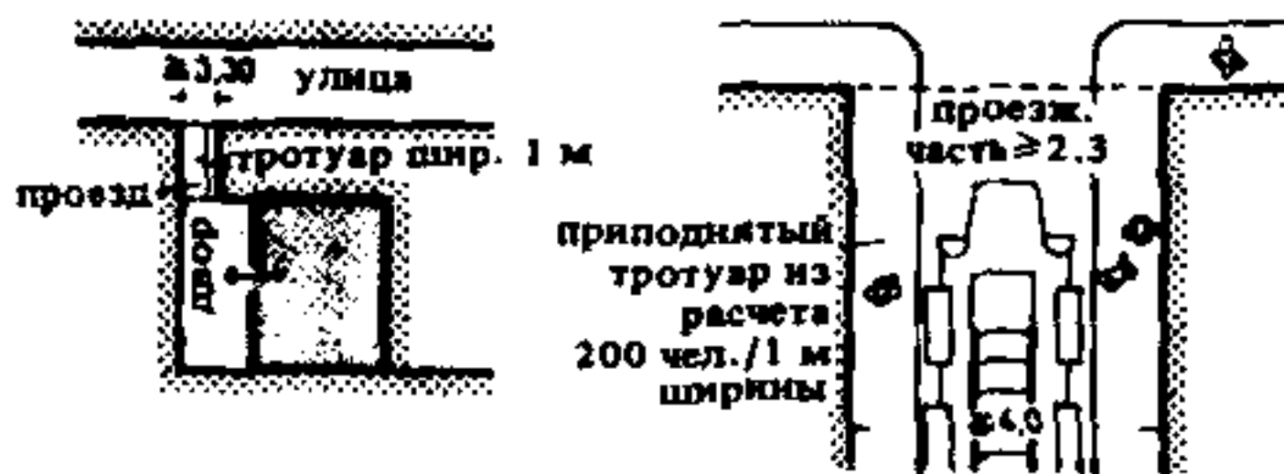
3. Кинотеатры с числом мест до 200 и уровнем пола зала, превышающим уровень земли не более чем на 4 м, могут располагаться в достаточно большом дворе с проездом на улицу
