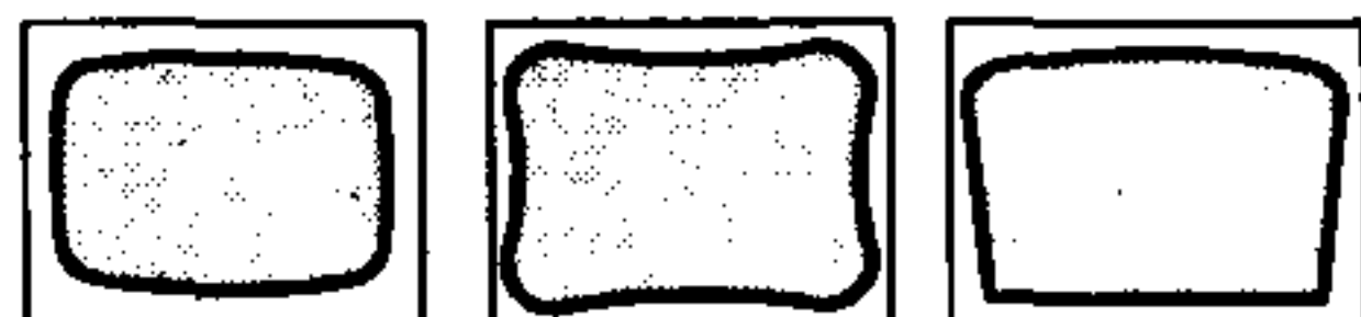
5. Для повышения выразительности изображений на экране поначалу зрительных залов следует придавать плоские очертания, хорошо выходящие в объем зала (по Бюде)
