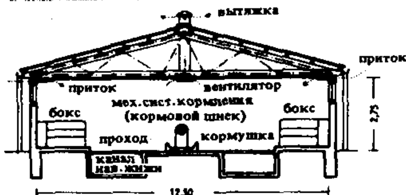
8. Поперечный разрез здания коровника для беспривязного содержания скота в боксах, оборудованного шнеком для подачи корма и каналом для удаления навозной жижи
