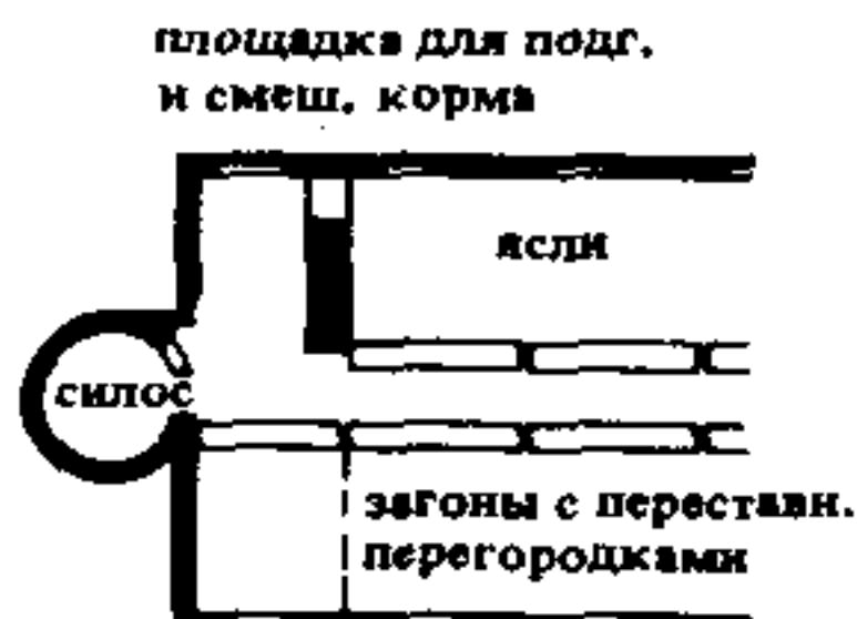
11. Рациональное расположение силоса и площадки для смешения корма в хлеву для овец
