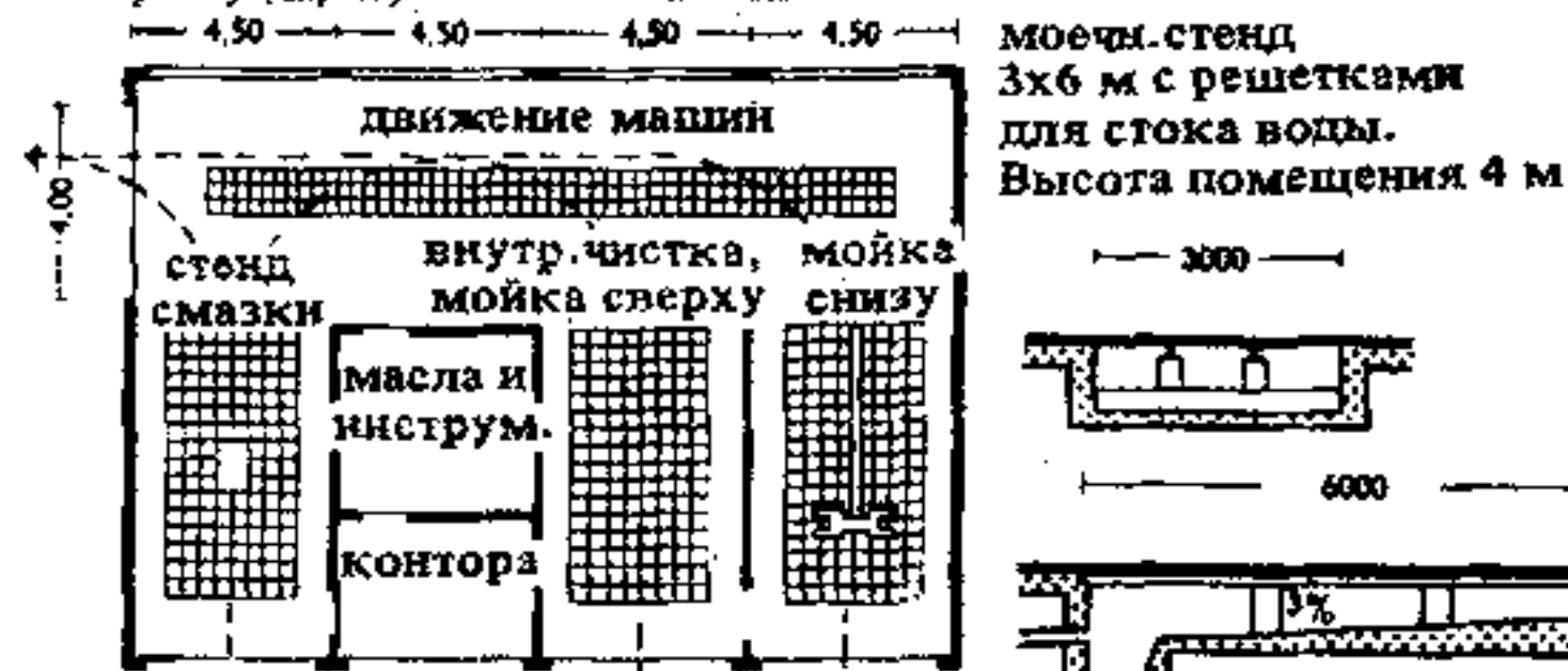
5. Двухъярусный пост технического осмотра. Разрезы по рабочему месту (слева) и по проходу (справа)
