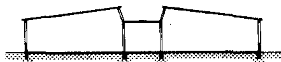
8. Классные помещения по обеим сторонам коридора, освещаемые и вентилируемые с двух сторон
