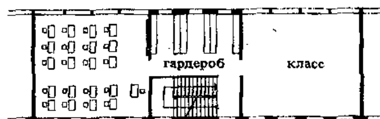
8. Два класса с двухсторонним освещением на каждой лестничной клетке многоэтажного здания. Архит. Шустер
