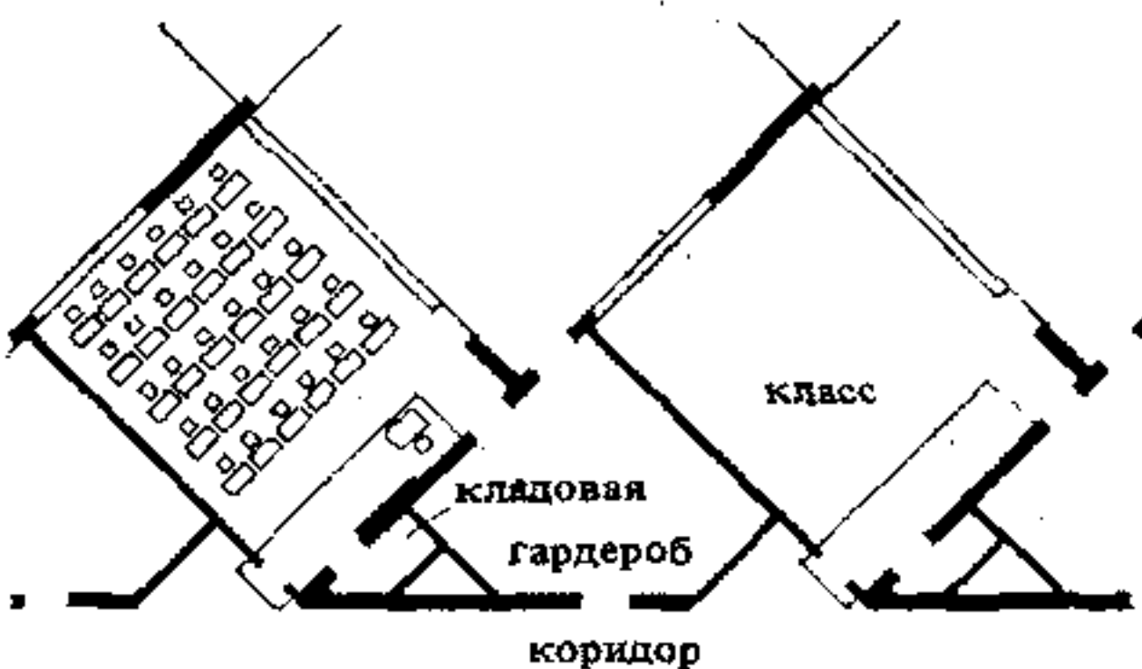
4. Класс дополнительно освещен сверху через высокорасположенное окно, недоступное для посторонних взглядов. Расширение коридора перед каждым классом, используется для размещения гардеробной и кладовой. Архит. Карбонара
