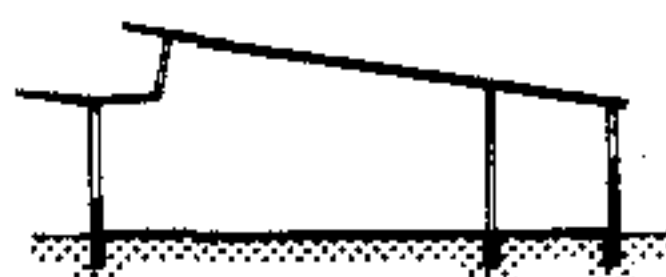
4. Высоко расположенный односторонний верхний свет. Бетонные козырьки предохраняют от прямой инсоляции
