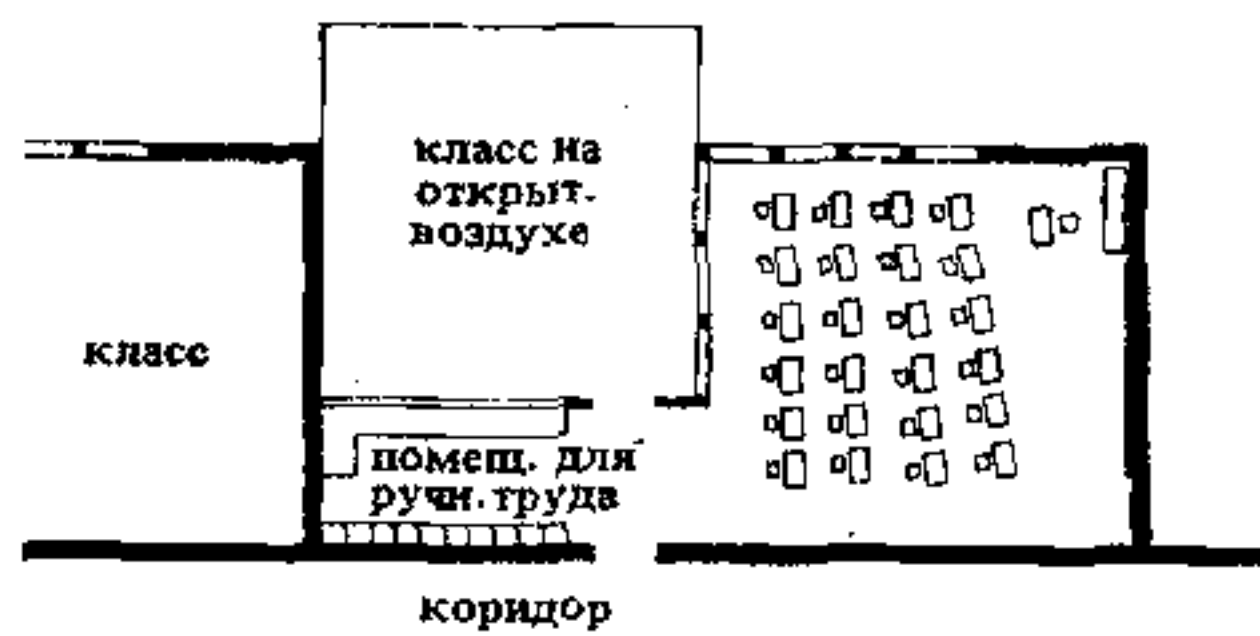
2. Блок, состоящий из класса, класса на открытом воздухе и помещения для ручного труда. Типовое решение. Архит. Нейтра
