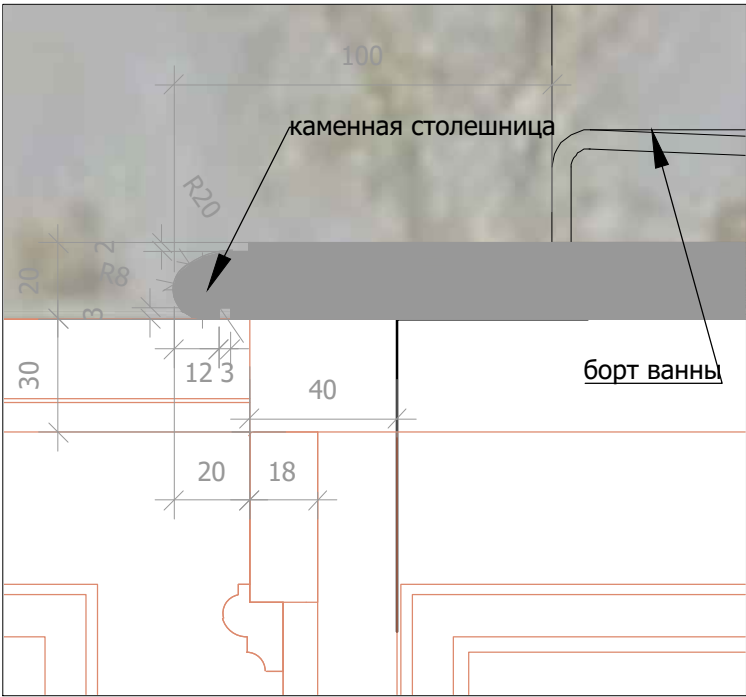
Столешница Фрагмент 4. М 1:2
